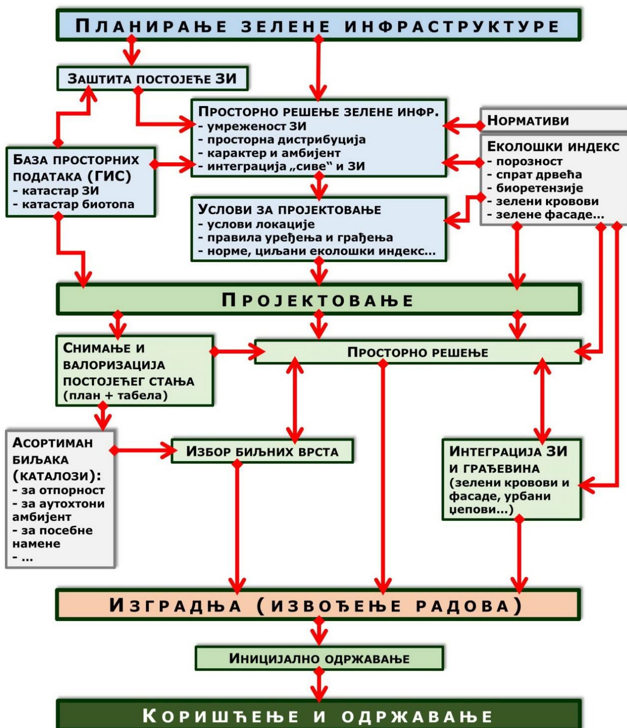
Слика 35: Шема основних корака реализације зелене инфраструктуре, од планирања, преко пројектовања и изградње, до фазе коришћења и одржавања
