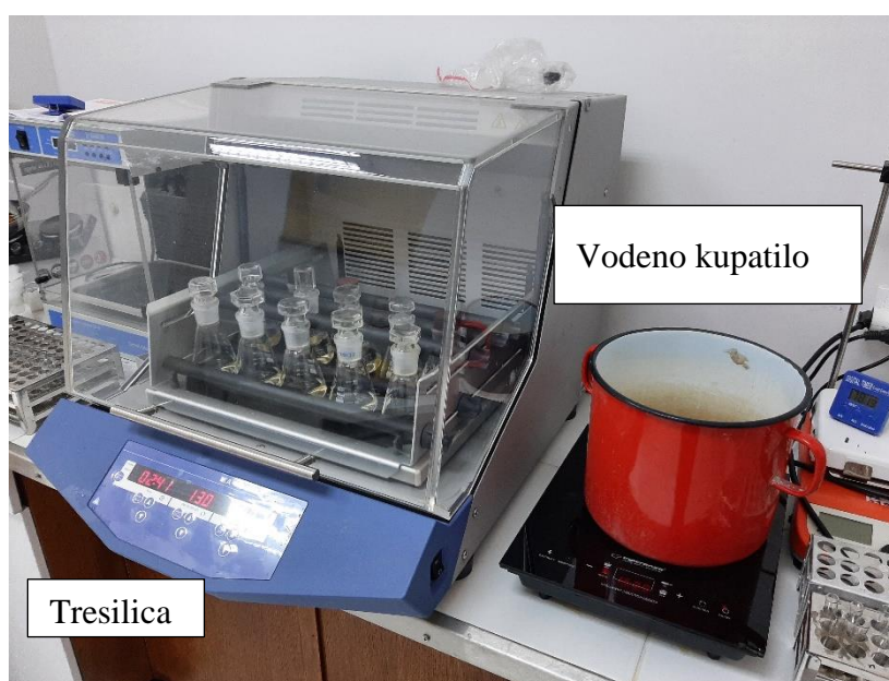
Slika 2.10. Eksperimentalna aparatura za sintezu FOS (preuzeto iz master rada Janković 2022.)
