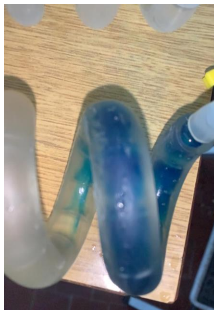
Slika 4.6. Ubacivanje obeležene supstance u SORP (a) i proticanje obeležene supstance kroz SORP (b)
