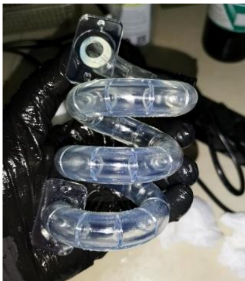
Slika 3.7. Odštampani spiralni element
