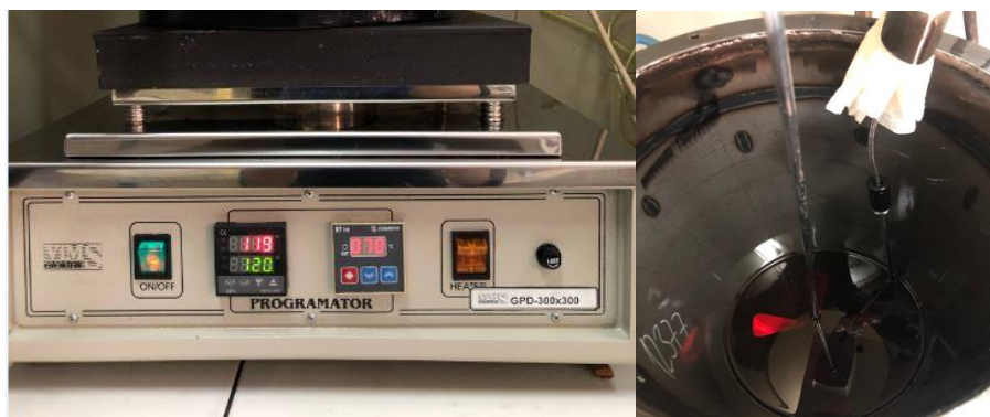
Slika 33. Programator temperature pilot postrojenja – levo i PT sonda uronjena u ulje - desno.
