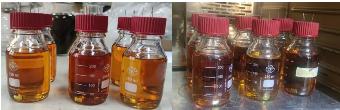
Slika 38. Modifikovani ASTM D 1275-15 testovi korozije srebra u okviru trećeg seta[118].
