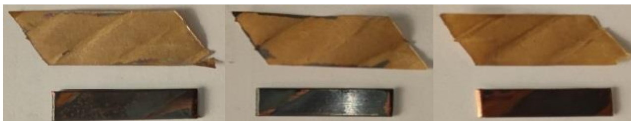
Slika 72. Izolacioni papir i bakar nakon IEC 62535 testa korozije: Ulje 1 – levo, Ulje 2 – sredina, Ulje 3 – desno [118].
