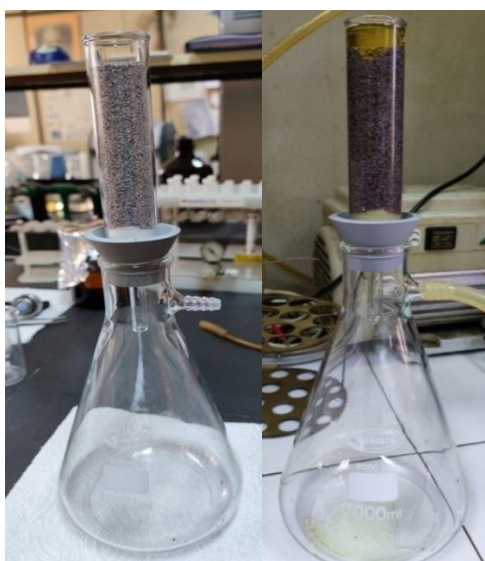
Slika 30. Sistem za laboratorijsku probu uklanjanja korozivnih jedinjenja sumpora sa malom staklenom kolonom ( lab-scale set up ) [115].
