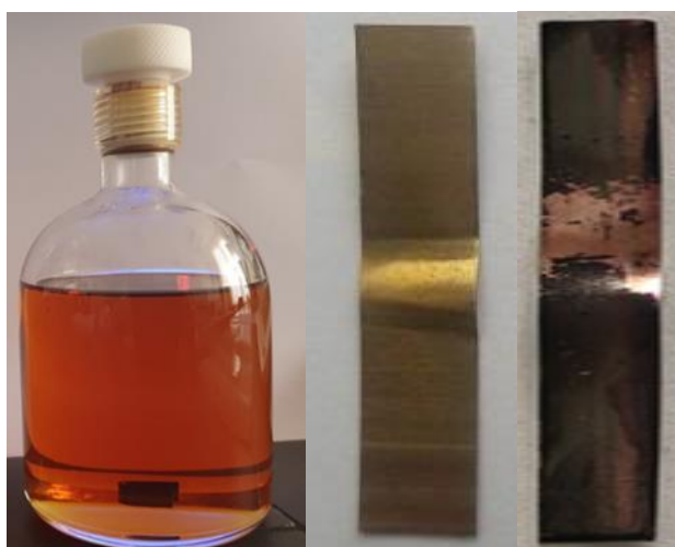
Slika 12. ASTM D1275-15 test korozije - levo, izgled bakarne pločice bez depozita \text{Cu}_2\text{S} nakon testa - sredina i sa depozitima \text{Cu}_2\text{S} - desno.
