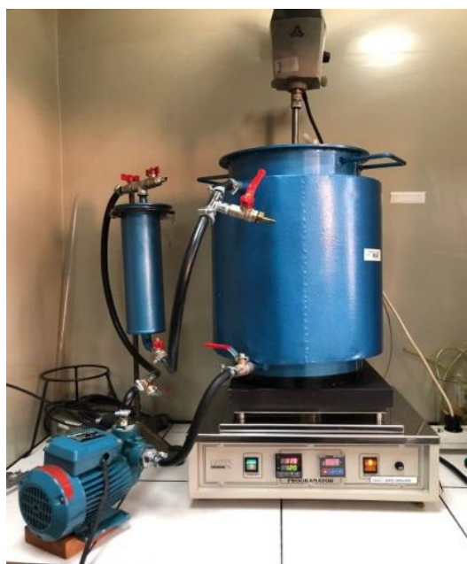
Slika 32. Sistem za laboratorijsku probu uklanjanja korozivnih jedinjenja sumpora na pilot postrojenju ( pilot-scale set up ) [115].
