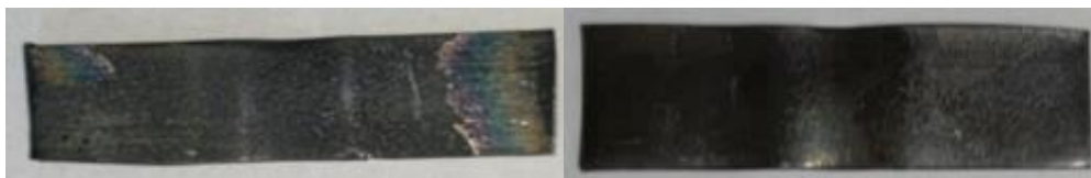
Slika 39. Izgled srebrnih pločica nakon ASTM D 1275-15 testa korozije: Ulje A – levo i Ulje B – desno [118].
