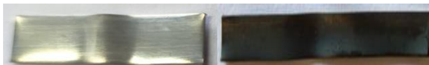
Slika 14. Izgled srebrne pločice nakon ASTM D 1275-15 testa: bez depozita Ag 2 S – levo i sa depozitima Ag 2 S – desno.
