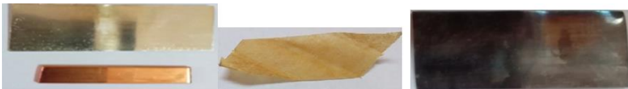
Slika 20. Srebrna pločica, bakarna pločica i papir nakon testa korozijske otpornosti ulja sa 200 mg/kg DBDS-a nakon 960 h na 100°C - levo i sredina, srebrna pločica nakon 72 h na 150°C – desno [22].
