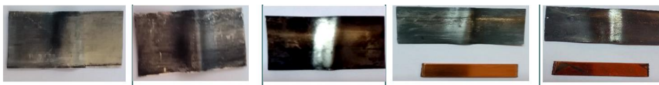
Slika 19. DIN 51353 test korozije sa uljem od 20 mg/kg S_8 na 40°C, 50°C, 60°C, 80°C i 100°C nakon 18 h (sa leva na desno) i IEC 62535 test korozije na 80°C i 100°C nakon 72 h [22].
