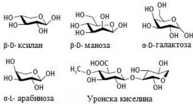
Слика 2.14. Основна структура различитих молекула хемицелулозе [25]
