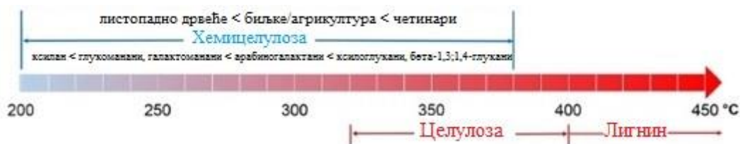
Слика 3.7. Температуре разлагања биомасе и полисахарида хемицелулозе [11]
