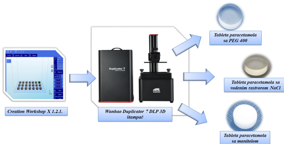
Slika 36. Prikaz procesa DLP štampe tableta paracetamola sa PEG 400, vodenim rastvorom NaCl i manitolom
