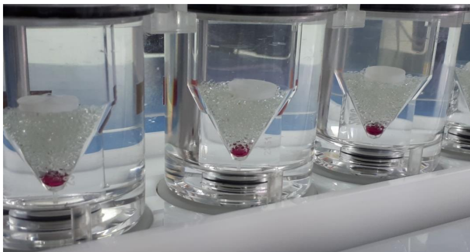
Slika 35. Prikaz ispitivanja brzine rastvaranja paracetamola iz 3D štampanih tableta u aparaturi tipa protočne ćelije
