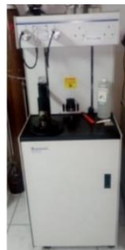
Слика 72. Живин порозиметар Autopore IV . (Извор: Елаборат лабораторијских испитивања, Лабораторија за испитивање материјала у културном наслеђу, Технолошки факултет Нови Сад).
