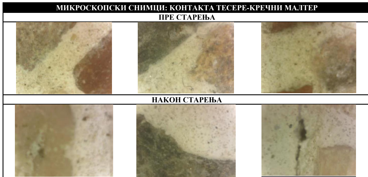
Табела 20. Скрининг мерења у току старења - Микроскопски снимци контаката тесера и кречног малтера без идентификованог одвајања, (Извор: Елаборат лабораторијских испитивања, Технолошки факултет Нови Сад).
