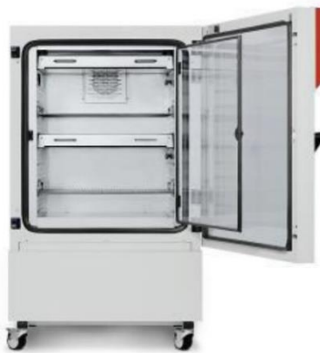
Слика 69. Климатска комора за старење материјала Binder Climate chamber KBWF 240 , (Извор: Елаборат лабораторијских испитивања, Лабораторија за испитивање материјала у културном наслеђу, Катедра за инжењерство материјала, Технолошки факултет Нови Сад).
