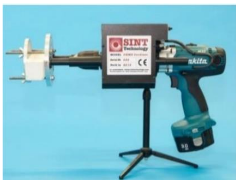
Слика 71. Уређај DRMS SINT Technology . (Извор: Елаборат лабораторијских испитивања, Лабораторија за испитивање материјала у културном наслеђу, Технолошки факултет Нови Сад).
