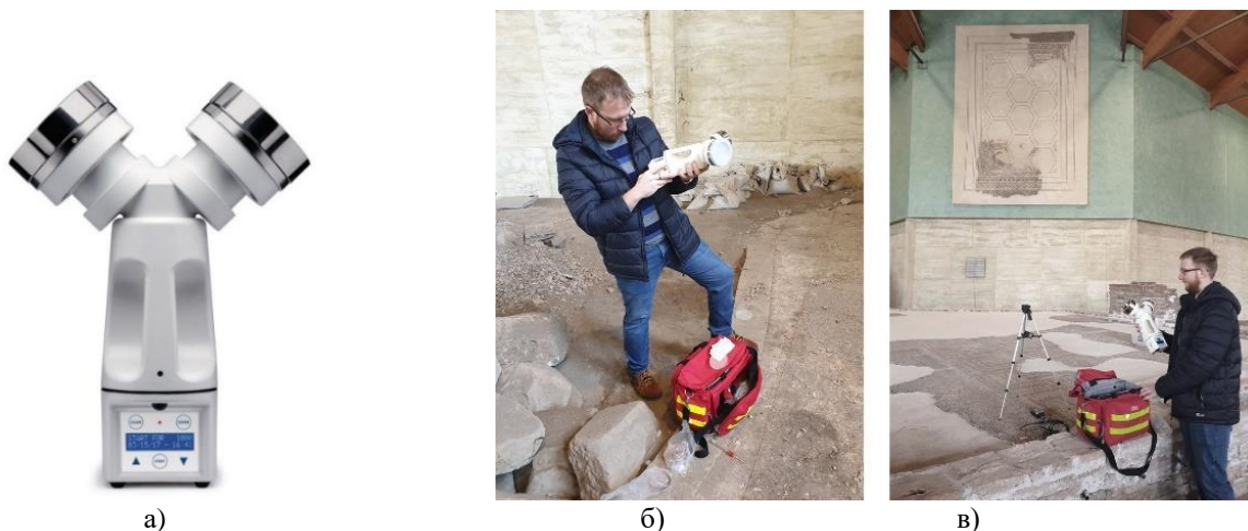
Слика 88. Узорковање ваздуха: а) Узоркивач ваздуха Air sampler, SAS Super DUO 360 , (Извор: https://in.vwr.com/store/product/11281609/vwr-sas-super-duo-360-air-samplers , приступљено 7.12.2023.); б) Узорковање ваздуха узоркивачем код мозаика М34; в) Узорковање ваздуха узоркивачем код мозаика М23, (Извор: Аутор).
