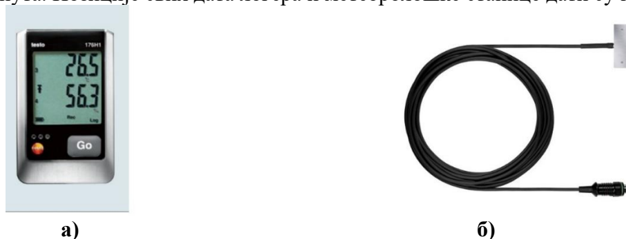
Слика 83. Уређаји за мерење температуре на површини мозаика M23 и M24: (а) дата логер Testo 176H1 (Извор: https://testo.rs/etaloniranje/testo-176-h1-temperature-and-humidity-data-logger/ , приступљено 5.10.2020.) и (б) површинска контактна температурна сонда Testo бр. 0628 7507, (Извор: https://www.testo.com/hr-HR/wall-surface-temperature-probe-ntc/p/0628-7507 приступљено 5.10.2020.)
