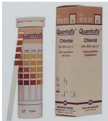
Слика 93. Quantofix мерне траке хлорида са кључем за одређивање заступљености у mg/L, (Извор: Снежана Вучетић и Јања Раногојец, Методологија испитивања историјских малтера , стр. 74.)
