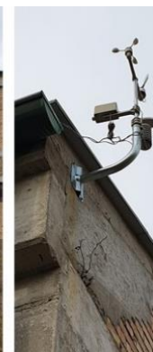
Слика 79 . Постављање метеоролошке станице PCE-FWS-20 , (Извор: Аутор).
