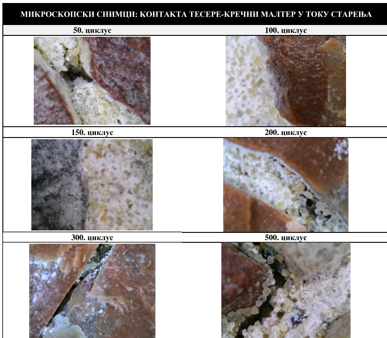
Табела 11. Скрининг мерења у току старења - Микроскопски снимци контаката тесера и кречног малтера са идентификованим одвајањем већ након 50 циклуса, (Извор: Елаборат лабораторијских испитивања, Технолошки факултет Нови Сад).
