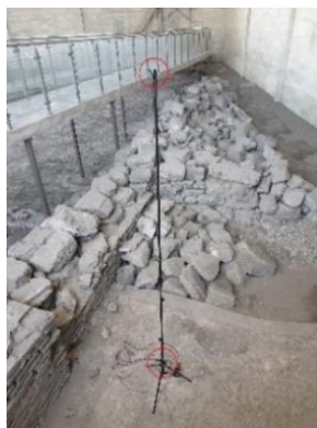
Слика 78 . Дата логери Testo 174h код мозаика M34 – ознаке позиција M34_V30 и M34_V350, (Извор: Аутор).
