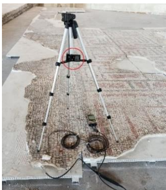
Слика 77 . Дата логер Testo 174h постављен код мозаика M23 – ознака позиције M23_V30, (Извор: Аутор).
