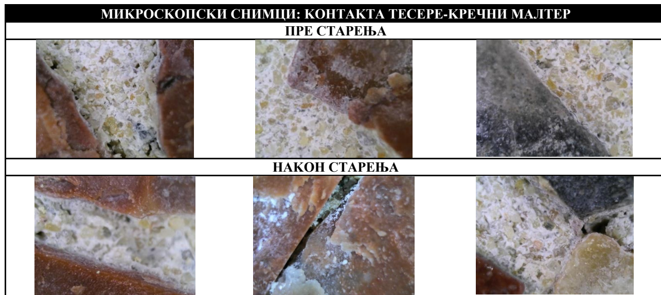
Табела 11. Скрининг мерења у току старења - Микроскопски снимци контаката тесера и кречног малтера са идентификованим одвајањем већ након 50 циклуса, (Извор: Елаборат лабораторијских испитивања, Технолошки факултет Нови Сад).
