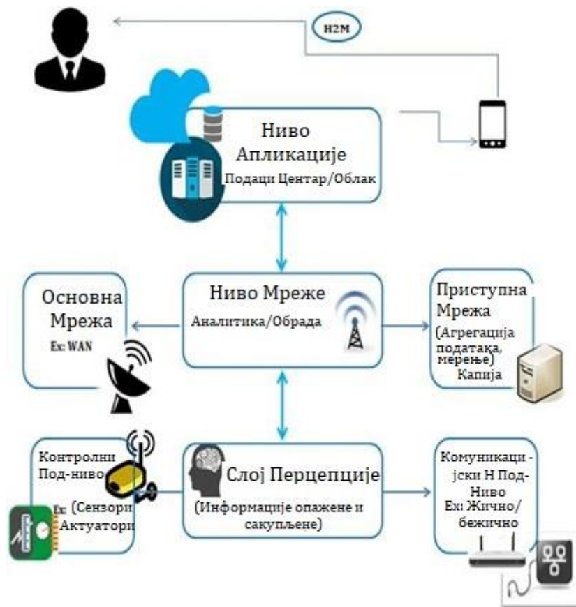
Слика број 10 – Архитектура IoT Ардуино уно табле (Alhebshi и коаутори, 2018)
