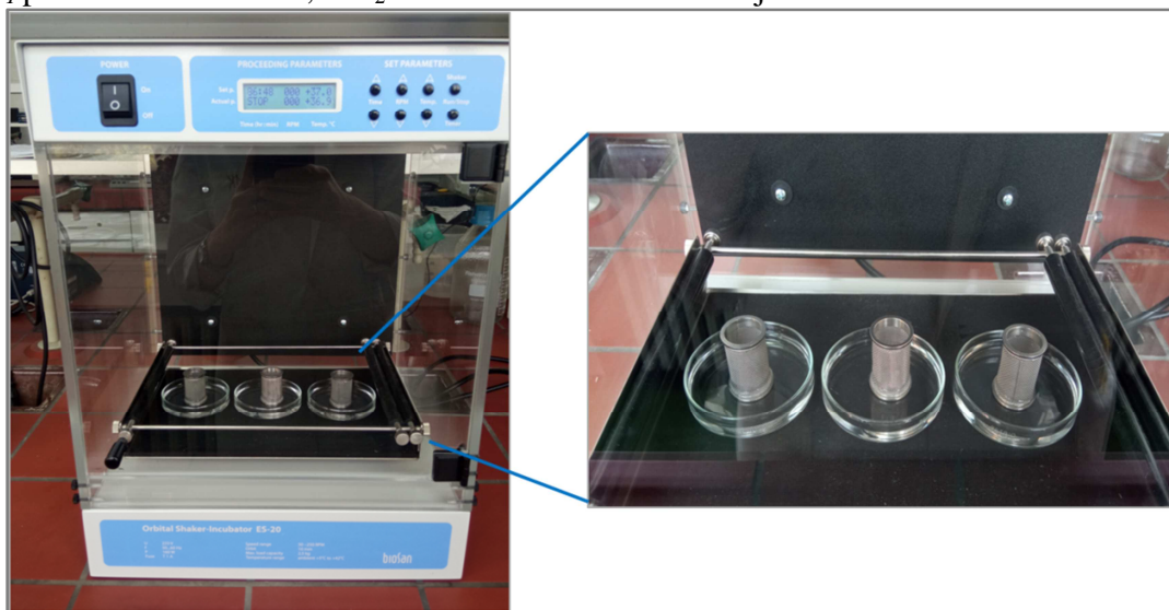
Slika 3.1. Aparatura za ispitivanje stepena apsorpcije medijuma
