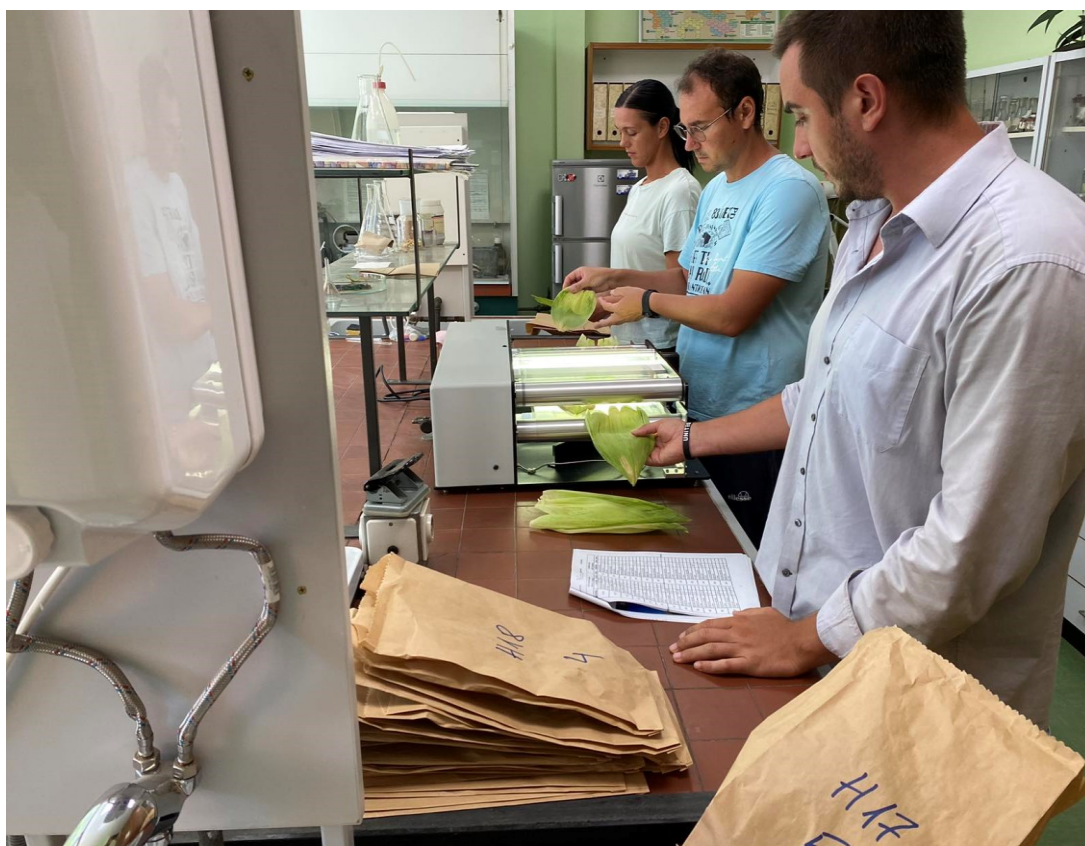
Slika 1. Merenje broja, dužine, debljine i površine listova kumušine kukuruza
