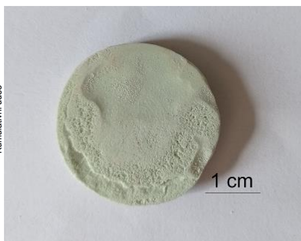
Slika 60. Raspodela veličine pora (levo) i fotografija uzorka (desno) staklene pene sinterovane na 900 °C: a) S2,5, b) S5, c) S7,5
