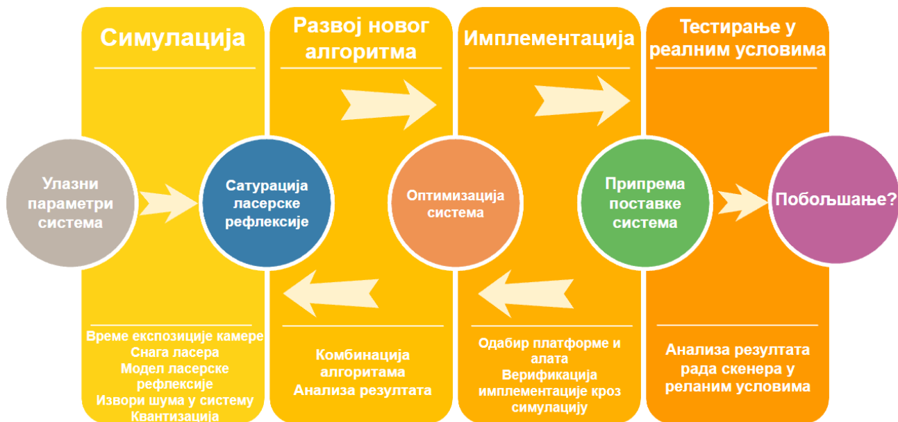
Слика 43. Дијаграм тока развоја алгорита, његове имплементације и тестирања у реалним условима рада
