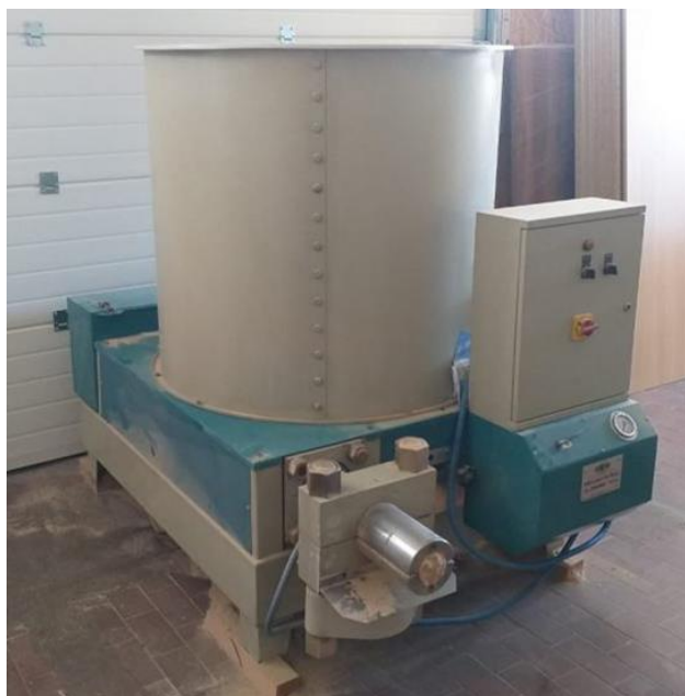
Slika 29. Briketirka koja je korišćena za pravljenje briketa.
