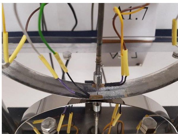
Slika 133: Instalacija ugibomjera sa kupastim nastavkom. Eksperimentalni set (A1): glatki luk i glatka oslonička ploča.
