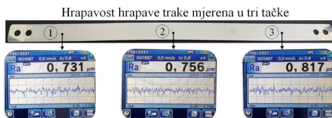
Slika 123: Profil hrapavosti i izmjerena vrijednost R_a za tri mjerene tačke na uzorku hrapave trake.
