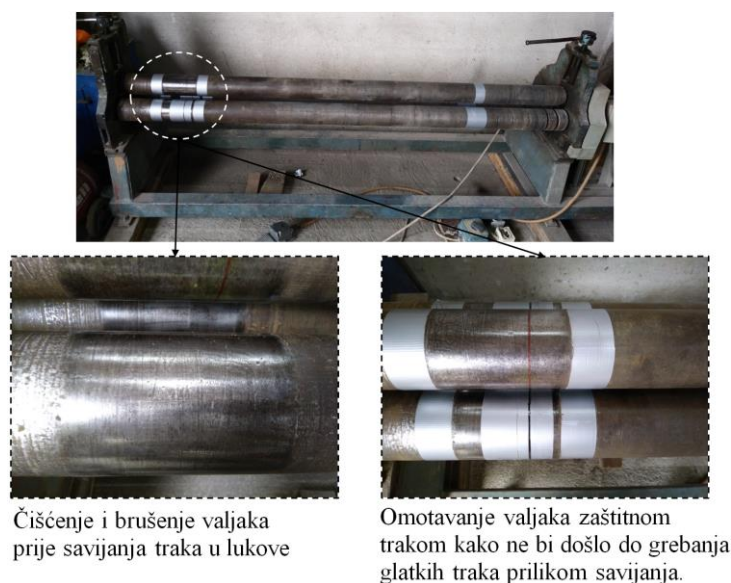
Slika 126: Pripremanje valjaka za savijanje traka u lukove.
