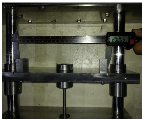
Slika 107: Razmak (prečnik) hvataljki polukružnog luka u toleranciji od pet stotih dijelova milimetra
