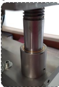
Slika 102: Precizna presa sa lukovima: a) torzioni zglobovi i mjerna ćelija, b) detalj veze honovane vodilice i klizača sa bronzanim ležajem, c) čeljusti za prihvatanje testnog uzorka luka
