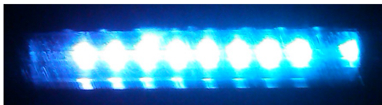
Слика 1.8: Фотографија вишесегментног Гримовог пражњења са чеоне стране при раду у једносмерном режиму.
