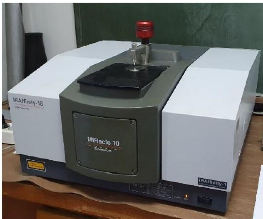
Слика 7.4 FTIR спектрометар марке Shimadzu IRAffinity-1s у моду ATR (преузето из Marinković 2022)
