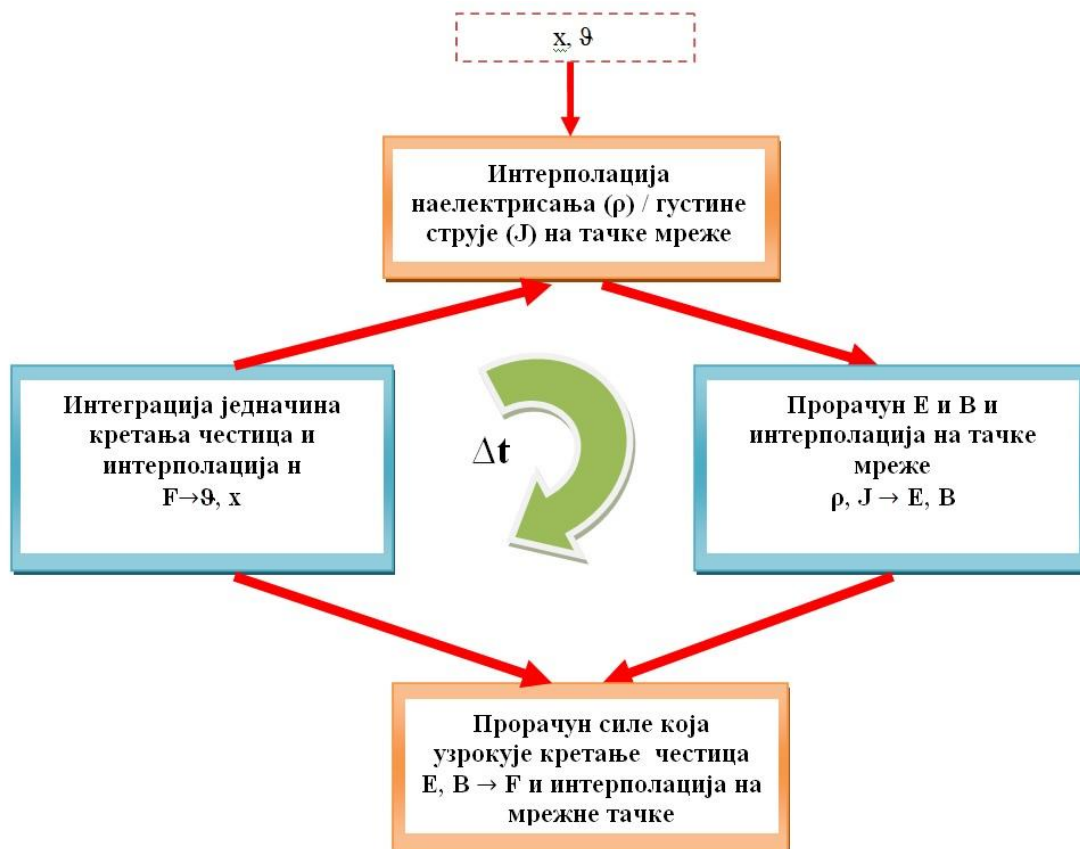
Слика 2.2 Графички приказ редоследа процедура „PIC“ методе
