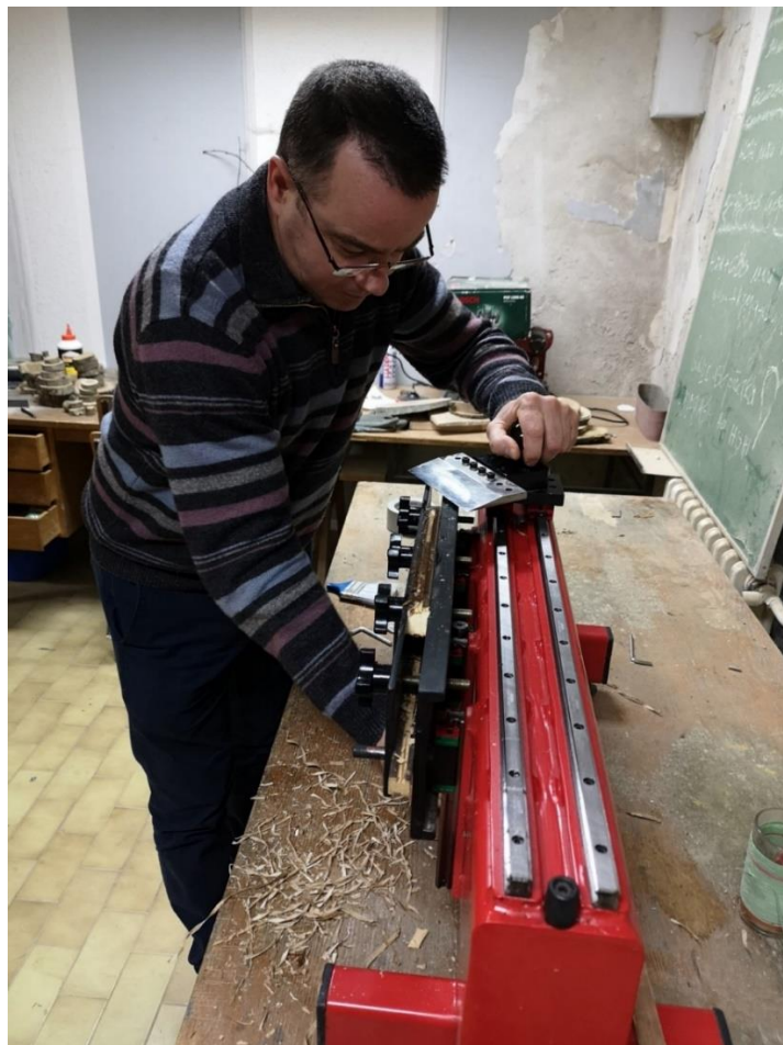
Слика 63. Површинска припрема узорака засецањем применом специјализованог уређаја Core microtome .
