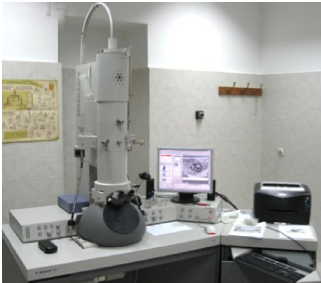
Slika 14: Transmisioni elektronski mikroskop (uz dozvolu i zahvalnost prof. dr Tamare Kravić Stevović, slika preuzeta sa insituta za histologiju Medicinskog fakulteta u Beogradu)
