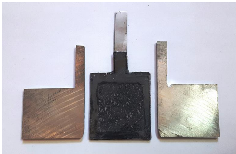
Slika. 3.2. Izgled elektroda korišćenih za konstrukciju realne ćelije.
