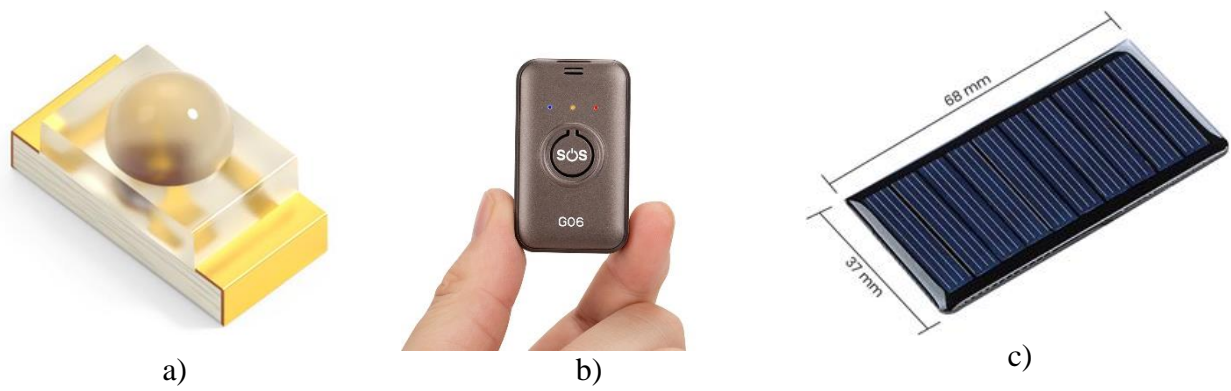
Slika 4.48. Izgledi a) minijaturne LED diode, b) GPS-SOS emitera i c) minijaturne fotonaponske ćelije.
