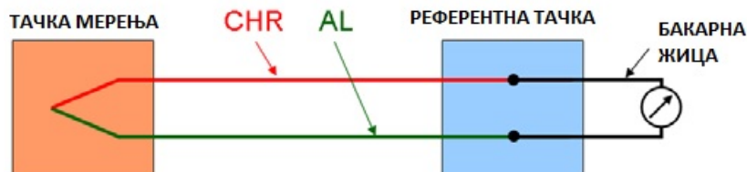
Слика 28: Увођење референтне тачке у колу са термопаром
