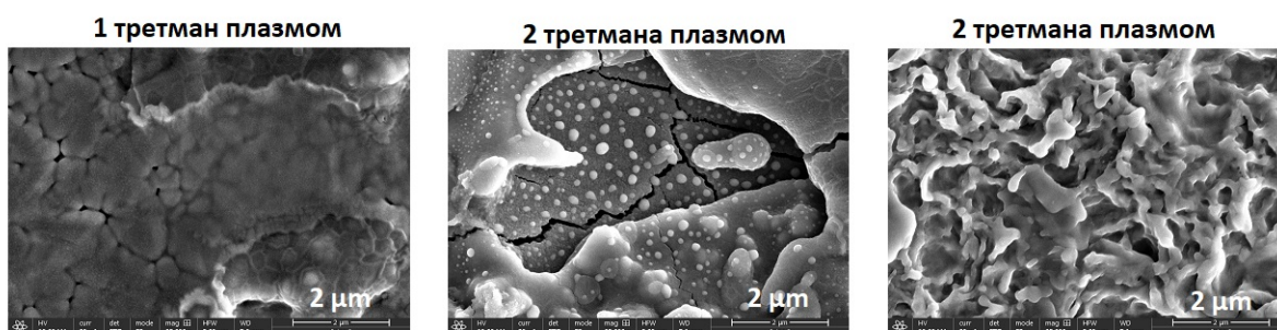
Слика 90: SEM слика граничног региона узорка 100Cr6 + TiN третираног плазмом два пута у МПК (Регион 2).
