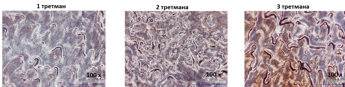
Слика 82: Регион 1 узорка челик 100Cr6 + TiN након једног, два и три третмана плазмом у МПК. (Оптички микроскоп, увећање 100 x)
