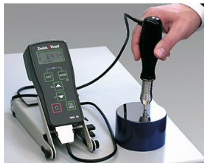
Слика 34: Апаратура за мерење тврдоће узорка. (Слика преузета из [62])
