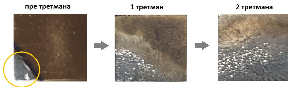
Слика 78: Фотографија узорка челик 100Cr6 + TiN пре третмана, након једног и након два третмана плазмом. (Кругом је означен регион на који није депонован TiN.)
