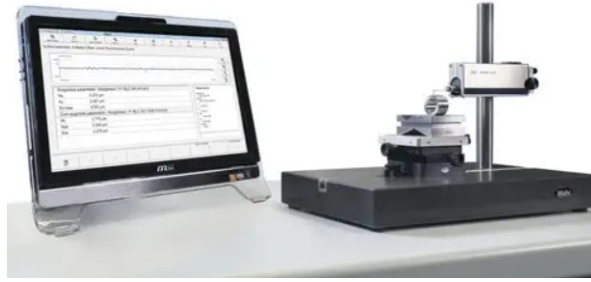
Слика 35: Апаратура за праћење храпавости узорака. (Слика преузета из [63])
